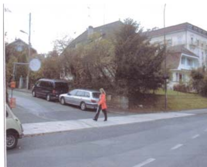
Matérialisation de la porte d'entrée de la zone 30 km/h par la construction d'un trottoir traversant
