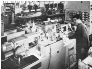
Une des « machines transfert », capable d'usinier quatre bâtis simultanément.
