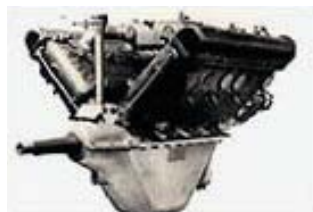
Moteur d'avion Hispano-Suiza V8 tout aluminium, 1914 ( www.hispano-suiza.com ).
