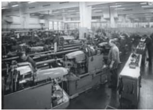
«Shed fabrication», machines de production, vers 1960. Répétitif, le travail consiste à charger la machine et à contrôler quelques pièces par série.
